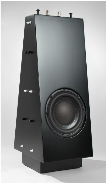
Fig.6 - Il volume di carico del woofer del diffusore GR Delta 4 R7. La sua forma è tale da minimizzare l'insorgenza di rimbombi od onde stazionarie interne.
